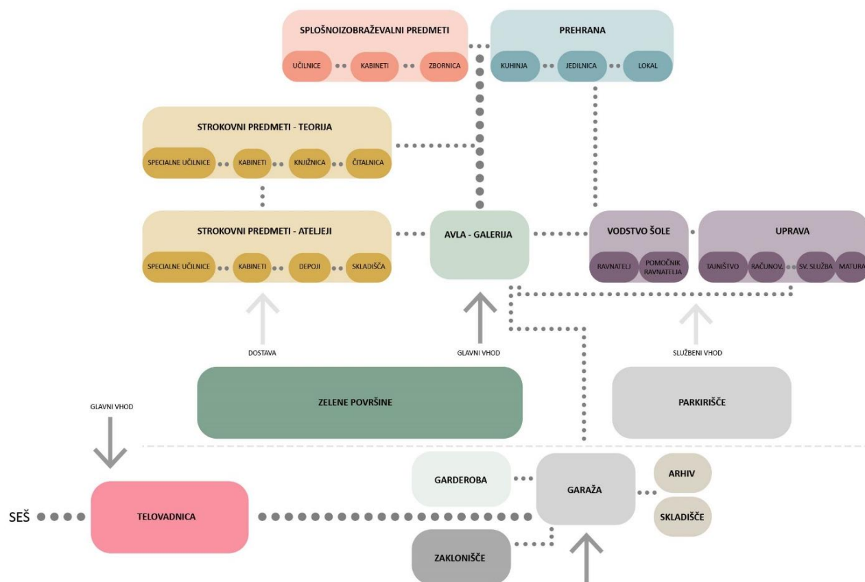
Slika 35: Diagram funkcionalnih sklopov in povezav
